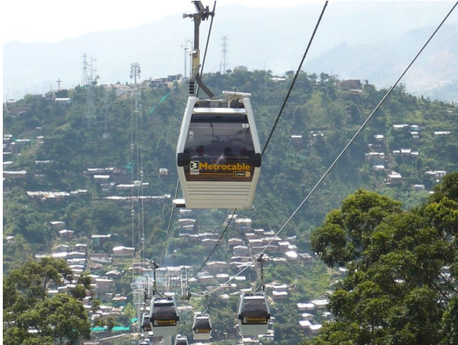
Metrocable. Medellín, CO. Las cabinas están ancladas al cable, que se mueve constantemente.
